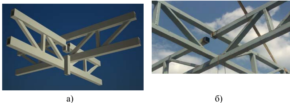
Рис. 3. Схема бесфасоночного узла перекрестных ферм с монтажным окном (а) и его снимок во время монтажа (б)
