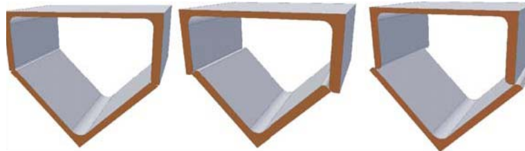
Рис. 7. Схемы компоновки сечений пятигранных профильных труб
