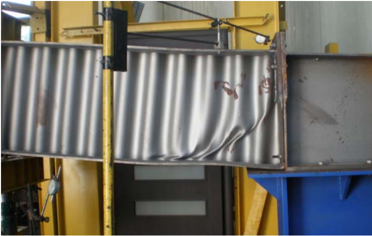
Рис. 1. Загальна втрата стійкості синусоїдно-гофрованої стінки при зсуві. Експериментальні дослідження на кафедрі металевих та дерев'яних конструкцій КНУБА (м. Київ)
