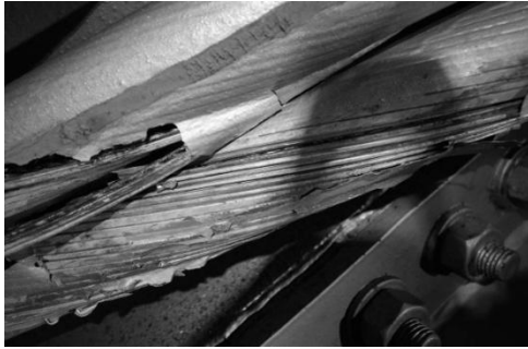
Рис. 16. Руйнування і обриви дротин канатів вант
