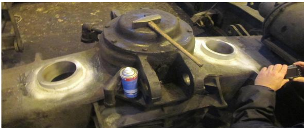
Рис. 4 – Модернізація рами візка електровоза серії ВЛ80 згідно проекту ВЛ80.ДНДЦ.001.00.000
