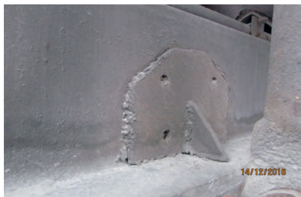
Рис. 5 – Тріщини у хребтовій балці вагонів хоппер-дозатор
