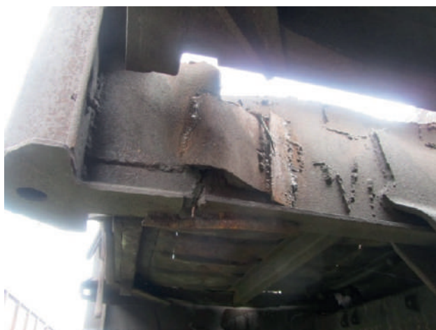
Рис. 3 – Причини виключення напіввагонів за пошкодженнями кузова і рами
