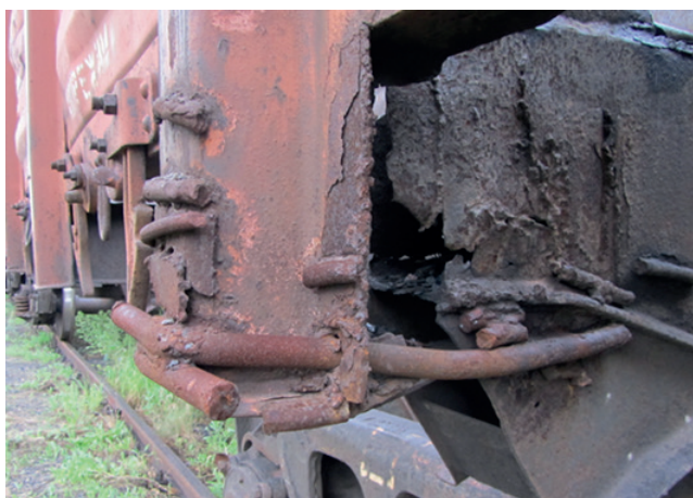
Рис. 1 – Типові руйнування кріплень вертикальних стійок кузовів вантажних напіввагонів
