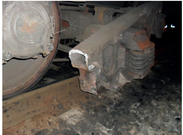
Рис. 1 – Типовий злам бокової рами візка типу 18-100
