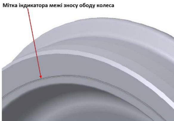
Рис. 7 – Індикація мінімально допустимої товщини обода колеса
