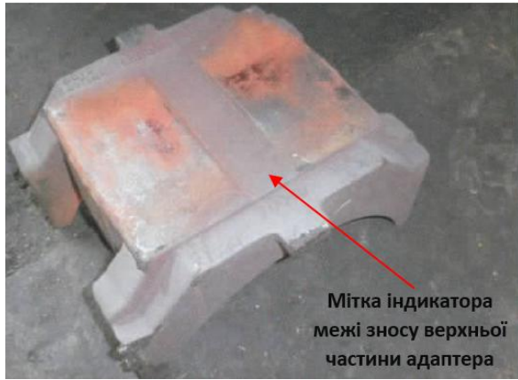
Рис. 6 – Адаптер з індикатором зносу опорної поверхні під бокову раму візків мод. 18-9810, 18-9855 (BARBER S-2-R)
