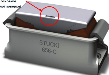
Рис. 5 – Варіанти виконання міток індикаторів межі зносу основної фрикційної поверхні кришки пружного ковзуна постійного контакту візка вантажного вагона:
