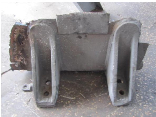
Фрагмент рами кузова електровоза ВЛ11, що відірвався
