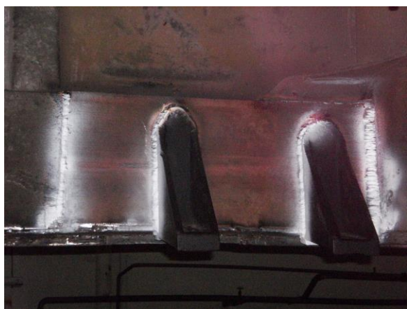
Відновлена рама кузова електровоза ВЛ11
