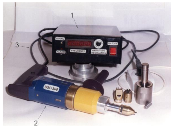
Рис. 12 - Загальний вид установки для високочастотної механічної проковки зварних з'єднань USP-300
