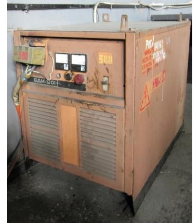
Рис. 2 – Застаріле зварювальне обладнання, що використовується в депо
