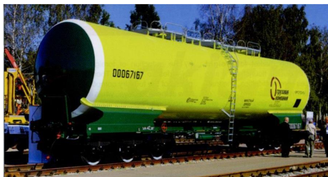
Рис.10 - Шестивісна цистерна для АТ «Татравагонка» (Словаччина) розроблена в ПКТБ ДПТУ
