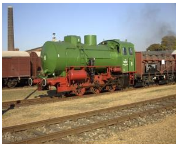
Мал. 4 – Зовнішній вигляд безтопкових пароаккумуляторних локомотивів в умовах їх реальної сучасної експлуатації
