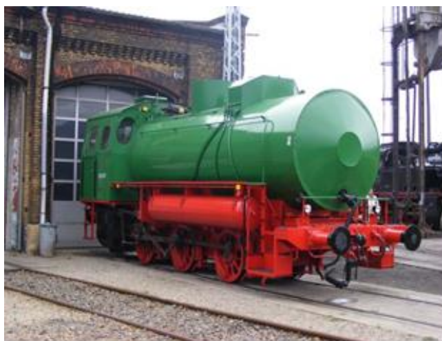
Мал. 4 – Зовнішній вигляд безтопкових пароаккумуляторних локомотивів в умовах їх реальної сучасної експлуатації
