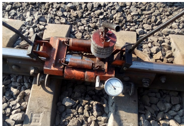
Рис. 2 – Загальний вигляд пристрою для вимірювання поздовжніх сил в рейкових плітях (в робочому положенні при проведенні експериментів)
