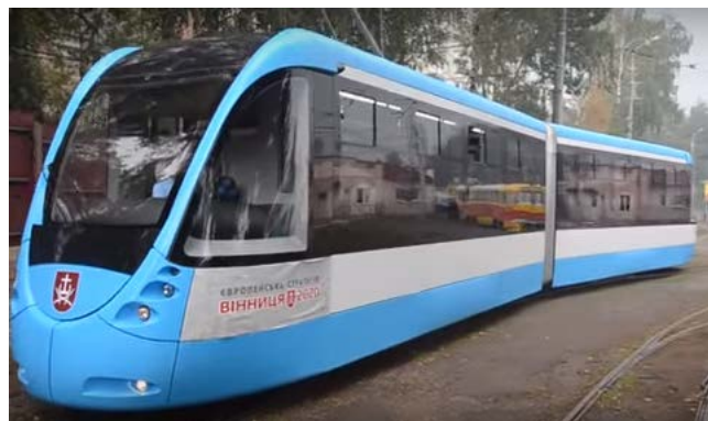
Рис.13 - Модернізований двосекційний трамвайний вагон типу КТ4Су
