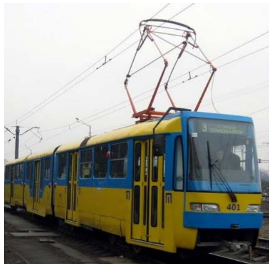
Рис.9 Модернізований трисекційний трамвайний вагон типу ТЗ RN
