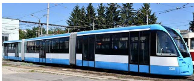
Рис.14 - Модернізований трисекційний трамвайний вагон типу КТ4Су
