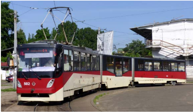
Рис.5 - Трисекційний трамвайний вагон типу K1M8
