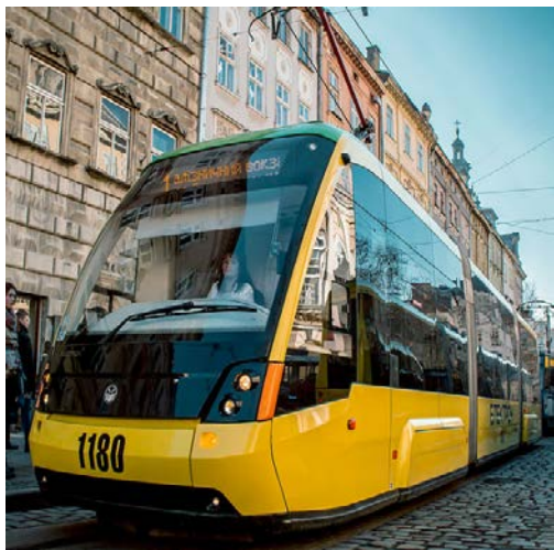
Рис.6 - Трисекційний трамвайний вагон типу «Електрон» для м. Львова
