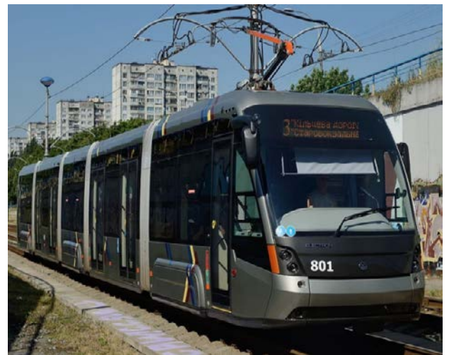
Рис.7 - П'ятисекційний трамвайний вагон типу «Електрон» для м. Києва
