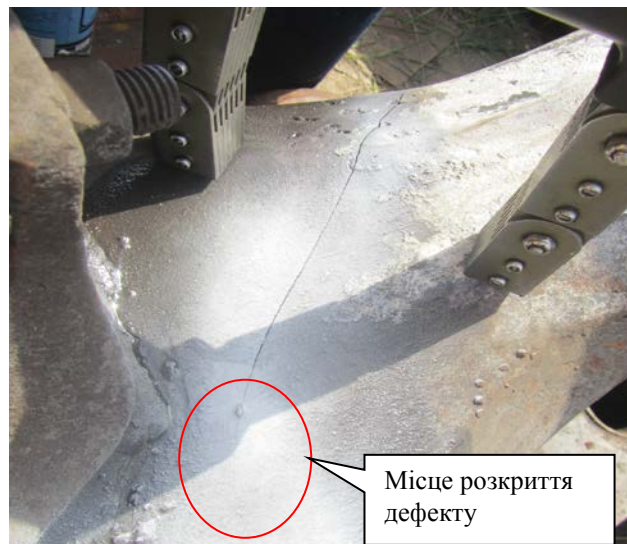
Рис. 4 – Дефекти металевих конструкцій виявлені за допомогою сучасних наборів для МТ
