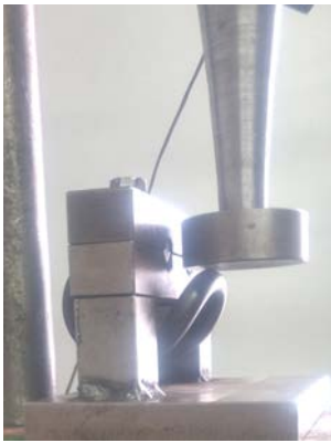
Рис. 2 – Використання розривної машини P-20 для вимірювання пружних властивостей пружних клем та діаграма жорсткості, що отримується
