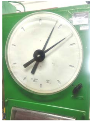
Рис. 2 – Використання розривної машини P-20 для вимірювання пружних властивостей пружних клем та діаграма жорсткості, що отримується
