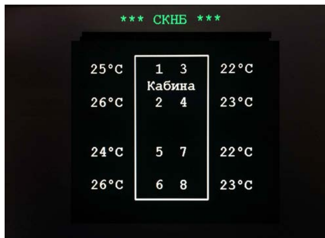
Рис. 9 – Поточні значення температур букс вагона 1 дизель-поїзда
