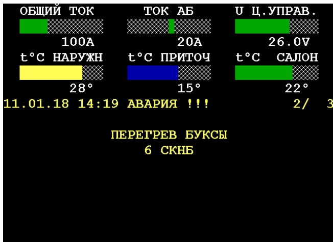
Рис. 13 – Повідомлення про аварійний перегрів букси вагона дизель-поїзду
