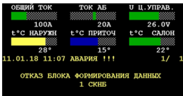
Рис. 17 – Повідомлення про аварійну відмову блока формування даних
