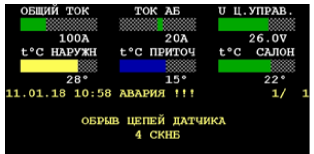
Рис. 16 – Повідомлення про аварійний обрив ланцюгів датчика і його позначення
