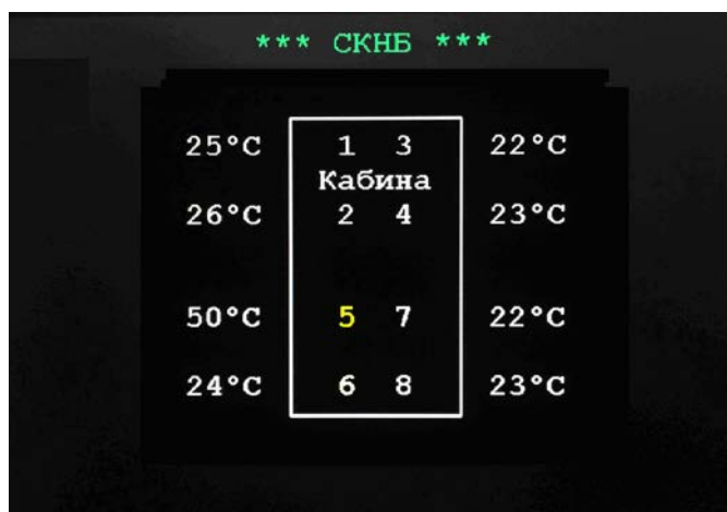
Рис. 11 – Виведення числового значення критичної температури букси (№ 5)
