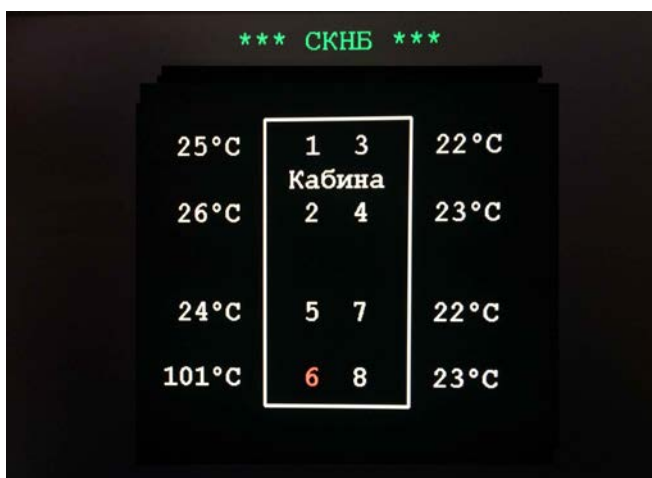
Рис. 14 – Представлення числового значення аварійної температури букси
