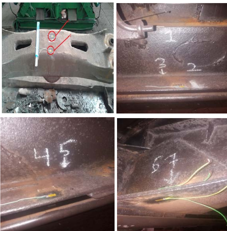
Рис. 8 – Місця встановлення тензорезисторів на несучих елементах дослідного напіввагону
