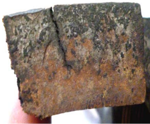
Рис.3 - Оплавлений та зламаний затискачі контактів електровозу ВЛ-80к після його пожежи
