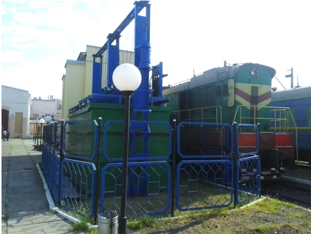
Рис. 1 - Индицирование дизеля тепловоза ЧМЭЗ на станции реостатных испытаний в локомотивном депо № 1, Одесса-Сортировочная
