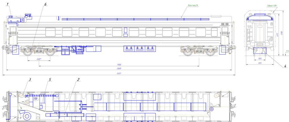
Рис.4 – Розміщення нових та оновлених вузлів у модернізованому пасажирському вагоні, де: 1- піддаховий кондиціонер АВК-25; 2-рециркуляційний канал; 3- екологічно чистий туалет; 4-бак-накопичувач; 5- пульт управління електрообладнанням вагону; 6 - візок модернізований
