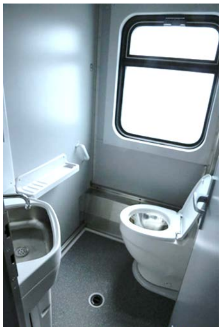
Рис. 1 - Інтер'єр модернізованого екологічно-чистого туалету пасажирського вагону
