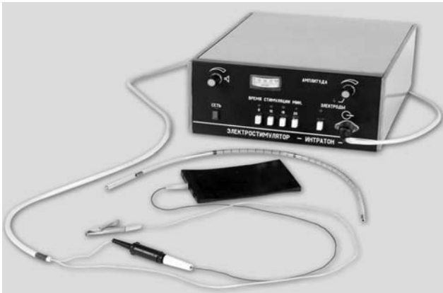
Рис. 1. Апарат «Інтрадон-1» (електростимулятор урологічний ЕСУР-30-1) з ендоуретральним електродом для проведення максимальної ЕС сфінктерного апарату сечівника
