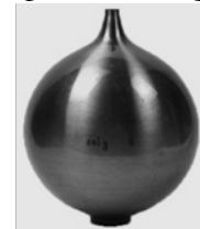
Рис. 2. Сферичний резонатор Гельмгольца
