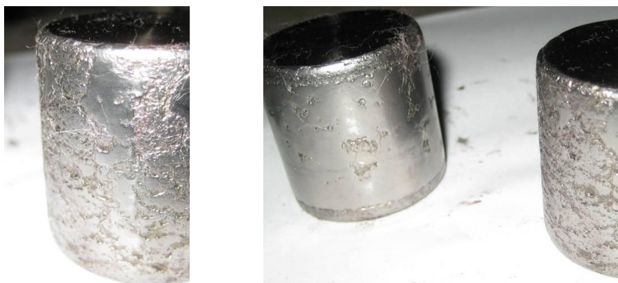
Рис.7. Следы осповидного износа на поверхности роликов верхнего ряда
