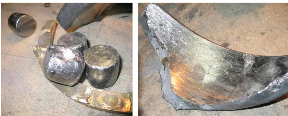
Рис.11. Полное разрушение одного из подшипников ходового колеса
