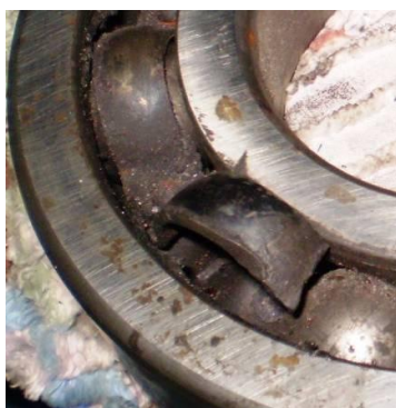
Рис.17. Цвета побежалости на сепараторе разрушенного подшипника
