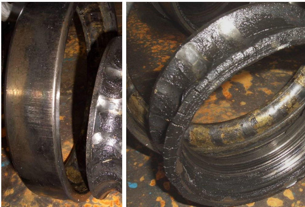
Рис.24. Повреждения радиально-упорного шарикоподшипника из-за недостатка смазочного материала
