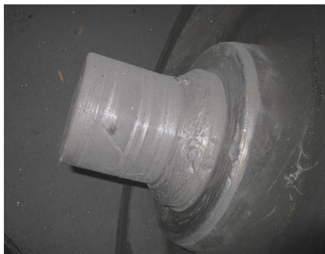
Рис.10. Сползание ходового колеса с оси
