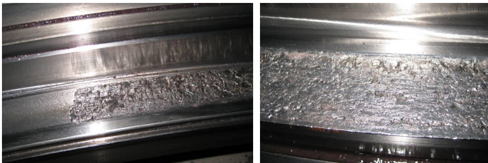
Рис.6. Усталостное выкрашивание на беговых дорожках подшипника
