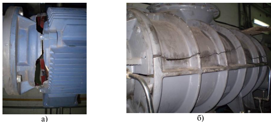
Рис.15. Разрушение корпуса двигателя (а) и корпуса (б) бустерного насоса
