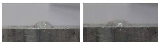
Рис. 3. Капля раствора на образце из алюминия после традиционного шлифования через 1 и 5 секунд времени
