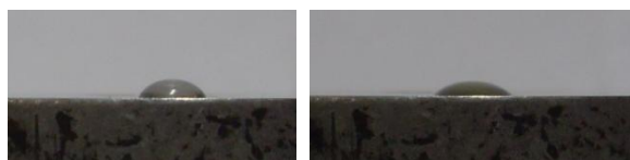
Рис. 7. Капля раствора на образце из стали после традиционного шлифования через 1 и 5 секунд времени
