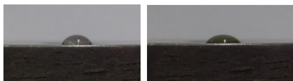
Рис. 8. Капля раствора на образце из стали после вибрационного шлифования через 1 и 5 секунд времени
