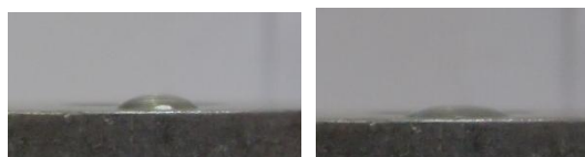
Рис. 4. Капля раствора на образце из алюминия после вибрационного шлифования через 1 и 5 секунд времени
