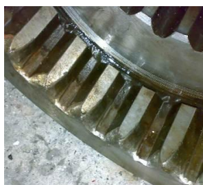
Рис. 3. Быстроходный вал и переключающее устройство (а), износ соединительной муфты (б) и шлицевого венца (в)
