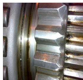
Рис. 3. Быстроходный вал и переключающее устройство (а), износ соединительной муфты (б) и шлицевого венца (в)
