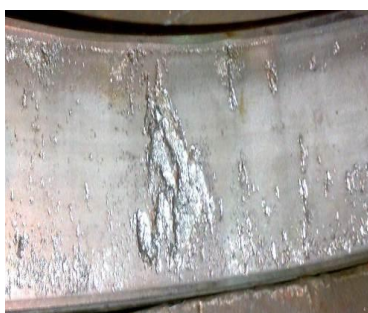
Рис. 4. Осповидное выкрашивание на кольце подшипника быстроходного вала (а), рабочая поверхность зубьев (б)
