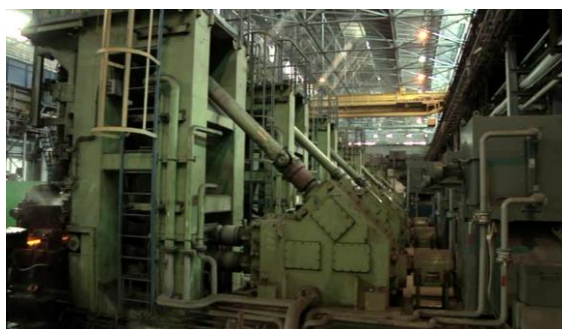
Рис. 1. Общий вид участка комбинированных клеток среднесортного стана 390
