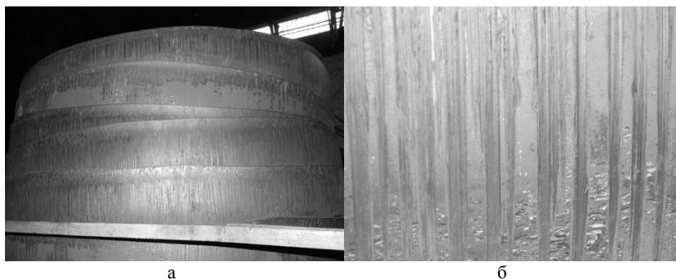
Рис. 1. Вид брака при штамповке днищ: а – общий вид; б – увеличенный вид.
