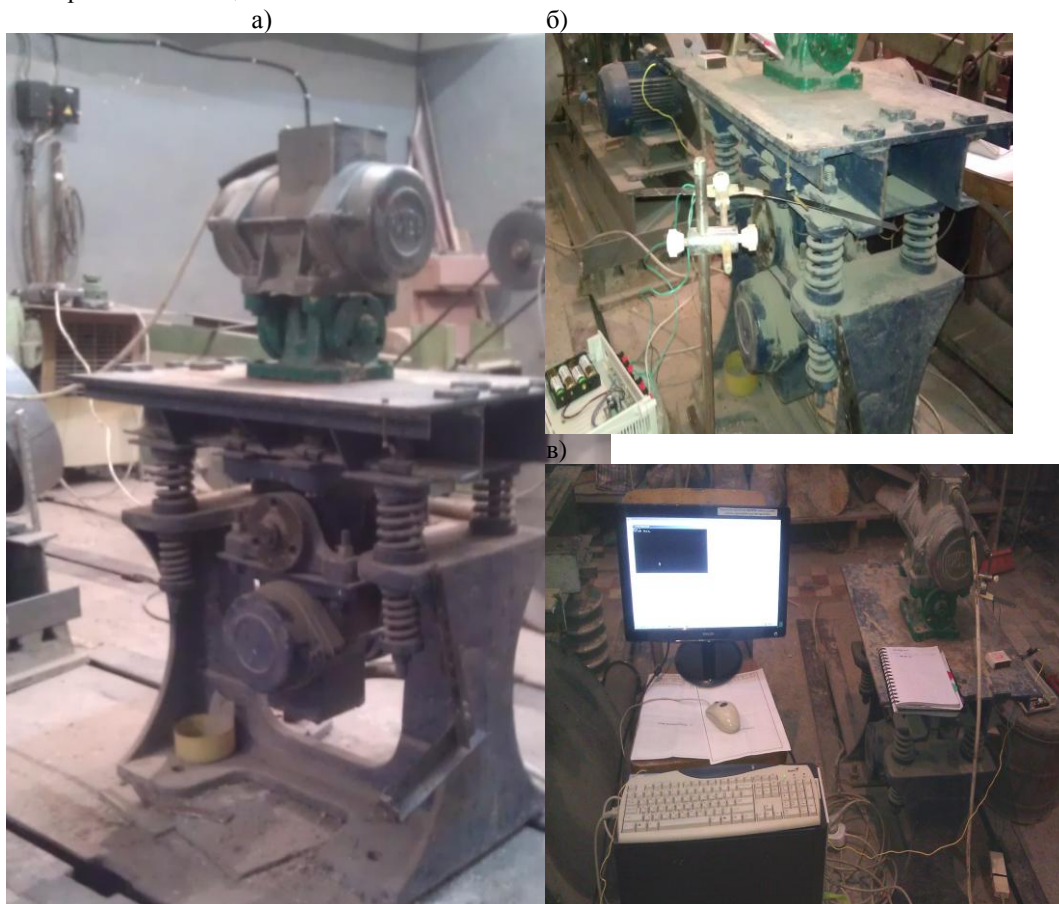
Рис. 3. Вібростіл для формування бетонних виробів: а) вібростіл з двома різночастотними збудниками коливань, перетворювач частоти Altivar 28 для асинхронних двигунів; б) тензодатчик у вигляді тензобалки з двома наклеєними тензорезисторами, з'єднаними напівмостовою схемою; в) аналого-цифровий перетворювач, розроблений і виготовлений на кафедрі механізації будівельних процесів.
