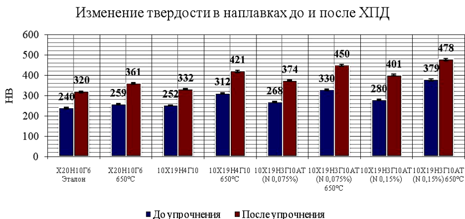
Рис. 2. Результаты изменения твердости многослойной наплавки испытываемыми порошковыми проволоками до и после ХПД (холодно-пластической деформации)
