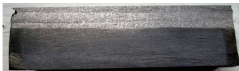
Рис.1. Макроструктура наплавленного и основного металла при использовании новой порошковой проволоки, х 16
