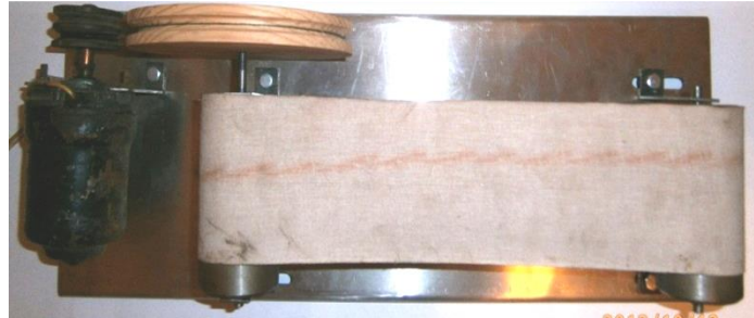
Рис. 2 – Сход ленты с цилиндрических барабанов на 11-й секунде работы модели конвейера
