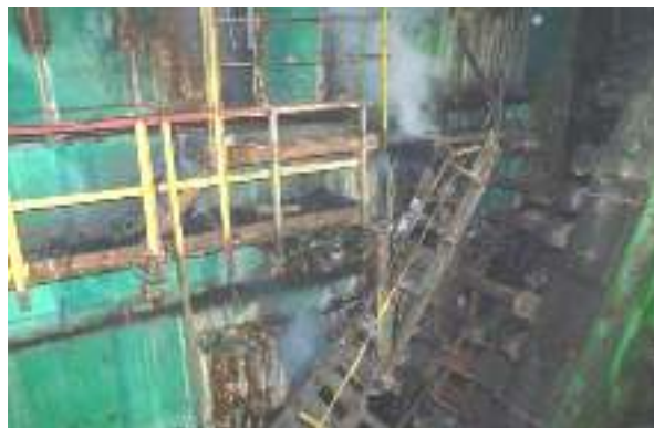
Рис. 2 – Результат коррозионного износа брони ручьев МНЛЗ
