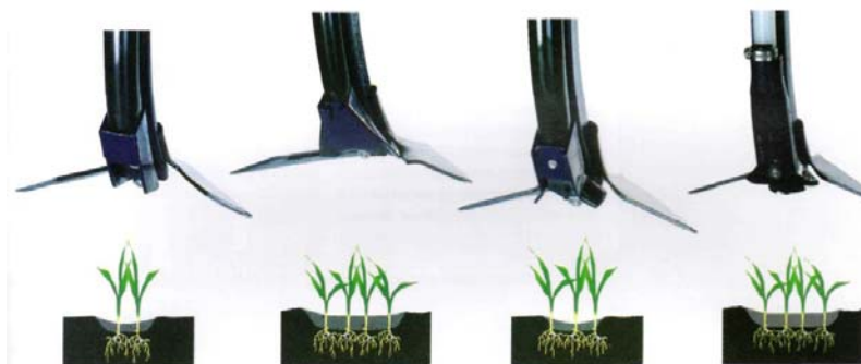
Рисунок 8 - Сошники екстирпаторного типу сівалок Concept 2000 і Maxim II фірми Morris для підгрунтової смугової сівби
