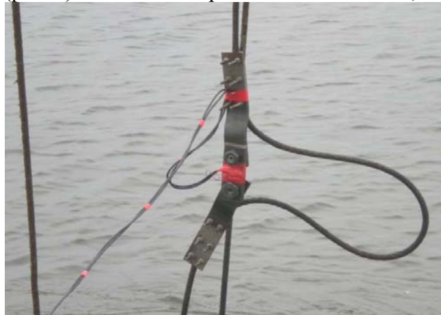
Рисунок 4 - Схема закріплення динамометра на тяговому канаті
