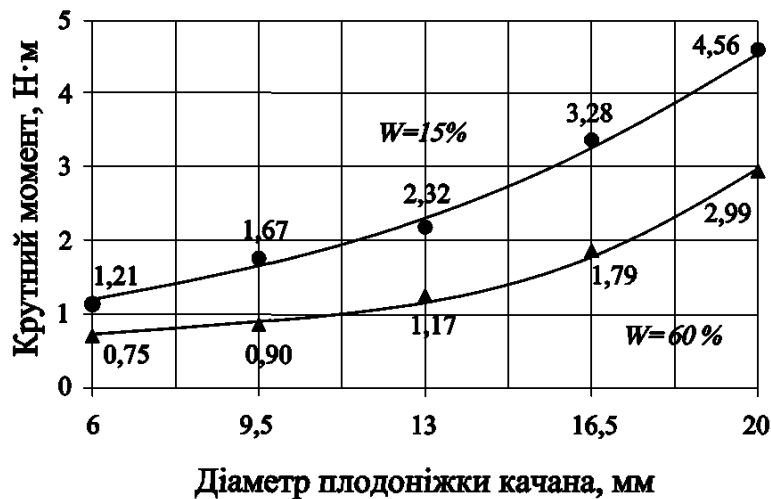
Рисунок 2 - Залежність величини крутного моменту від діаметру плодоніжки
