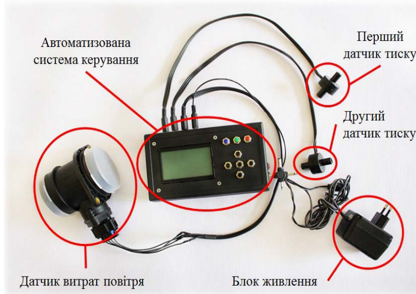
Рисунок 4 – Макетний зразок комплекту устаткування контролю вакуумметричних параметрів доїльного обладнання
