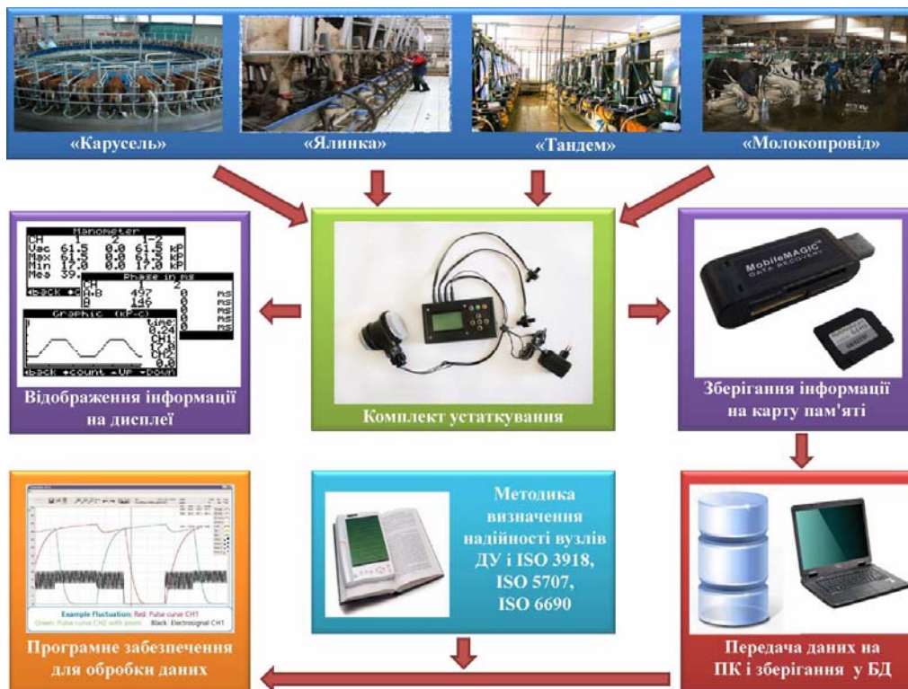
Рисунок 2 – Технологічна схема контролю вакуумметричних параметрів доїльного обладнання
