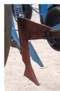
Рисунок 3 – Загальний вигляд та схема встановлення сошників на глибину сівби
