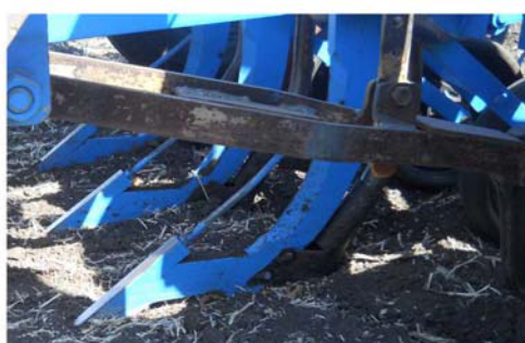
Рисунок 3 – Загальний вигляд та схема встановлення сошників на глибину сівби
