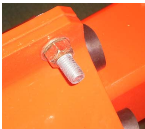
Рисунок 8 - Вихід стрижня болта за межі гайки на сівалці Pottinger
