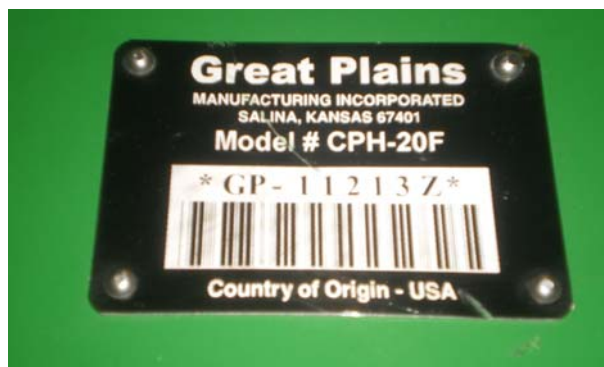
Рисунок 6 - Неповні реквізити маркувальної таблички сівалки Great Plains
