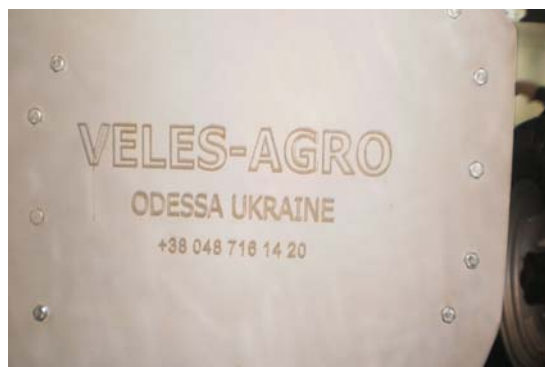
Рисунок 5 - Неповні реквізити маркувальної таблички сівалки СЗМ «Ника»
