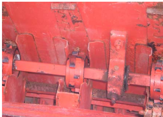
Рисунок 2 - Корозія зернотукового ящика сівалки СЗ-3,6
