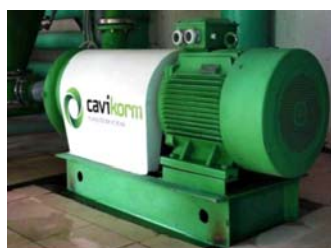
Рисунок 3 - Роторний подрібнювач диспергатор РІД-2
