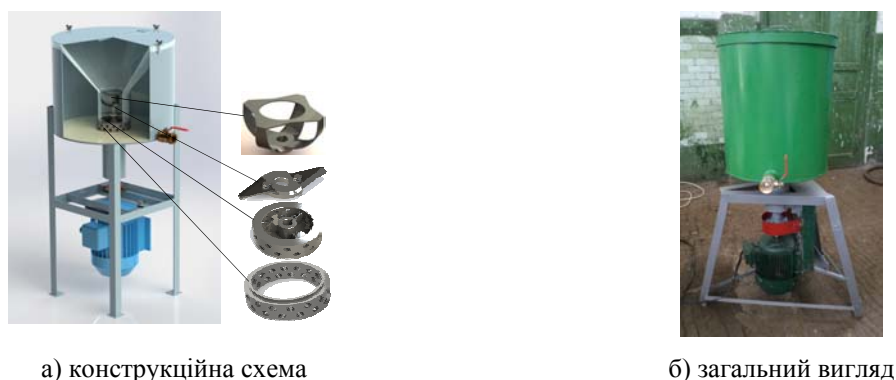
Рисунок 5 – Роторний кавітаційний диспергатор РоКаДі - 2 (розробка Відділу ННЦ «ІМЕСГ» НААН)
