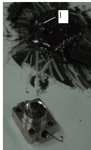
Рисунок 2 - Нанесення пастоподібного металполімера на поверхню вставки
