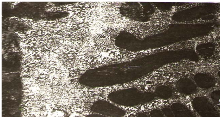
Рисунок 1 – Мікроструктура евтектичного покриття (ЕП) №1, (x 400)
