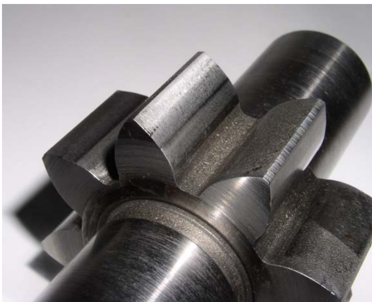
Рисунок 1 - Цапфи, вершини і торці зубців шестерні насоса НШ-32У зі слідами абразивного зношування
