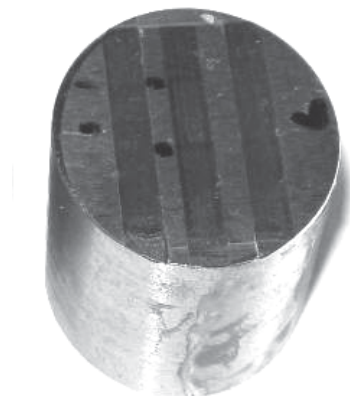
Рисунок 4 – Загальний вигляд отриманих канавок на зразку після обробки дослідним інструментом
