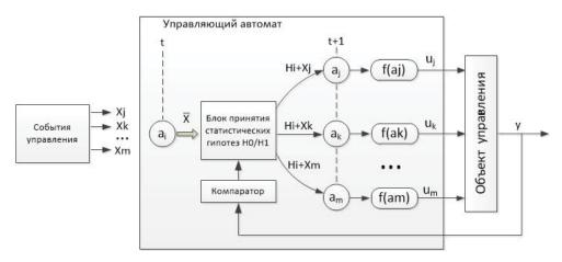
Рисунок 3 - Структура конечного автомата со статистическим блоком
