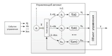
Рисунок 2 – Компаратор в структуре конечного автомата
