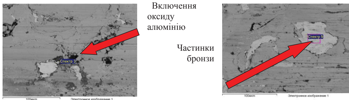
Рисунок 8 – Мікроструктура ЕДП після випробувань на тертя зношування
