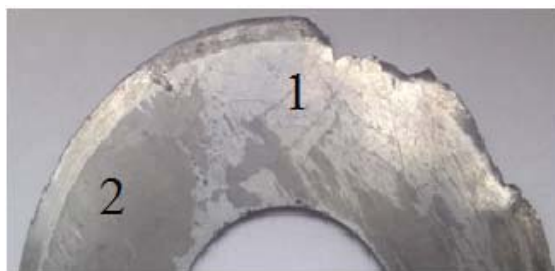
Рисунок 2 – Поверхность дискового ножа с нанопокрyтием CrN (300нм) после эксплуатации 1, 2 зоны измерения
