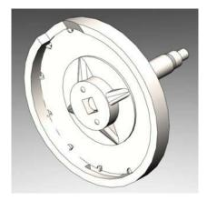
Рисунок 2 – Тривимірна модель запропонованого пневмомеханічного висівного апарата Джерело: розроблено автором на підставі [6]
