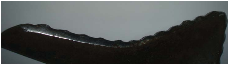
Рисунок 2 – Загальний вид зносу експериментально лапи (вид знизу)
