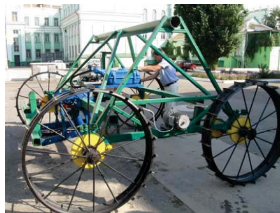
д) Дослідний зразок спеціалізованого електрифікованого ширококолісного агрозасобу ТДАТУ
