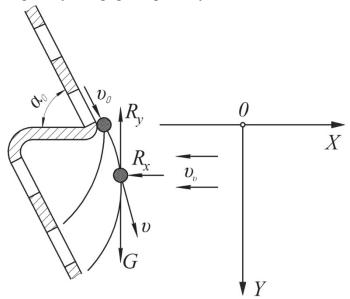
Рисунок 1 — Технологічно-розрахункова схема сходу частки з конічного елементу опорної поверхні решета
