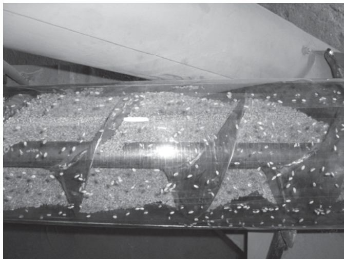
Рисунок 5 – Рух зернового матеріалу в гвинтовому конвеєрі
